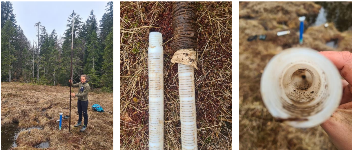
Abb. 26: Herausnahme und Untersuchung eines alten Pegelrohres, erstes Bild: gesamtes Pegelrohr, zweites Bild: geschlitztes Pegelrohr nach Abziehen des Filterstrumpfes, drittes Bild: Pegelrohr von Innen (Quelle: Eigene Aufnahme)
