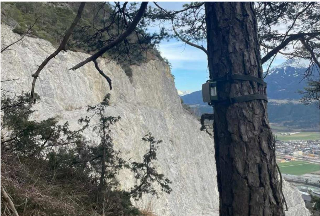
*Abb. 7: Beispielabbildung für die Aufhängung der Horchboxen. In diesem Fall die Horchbox im Untersuchungsgebiet Martinswand*
